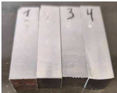
Фиг. 1. Заготовки от стомана S355J2 преди различни режими на термична обработка
